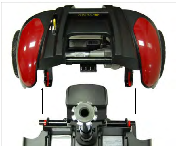
Imagen 19. Alineación del tren de manejo
