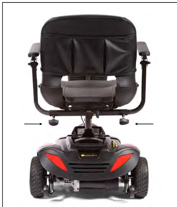
Imagen 6. Ajuste de anchura del reposabrazos
