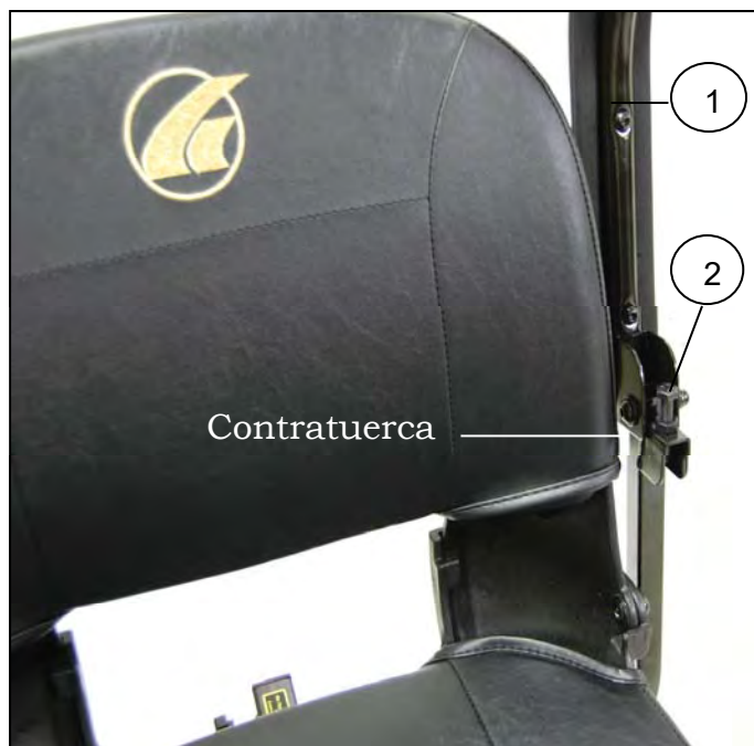
Imagen 7. Ajuste de ángulo del reposabrazos
