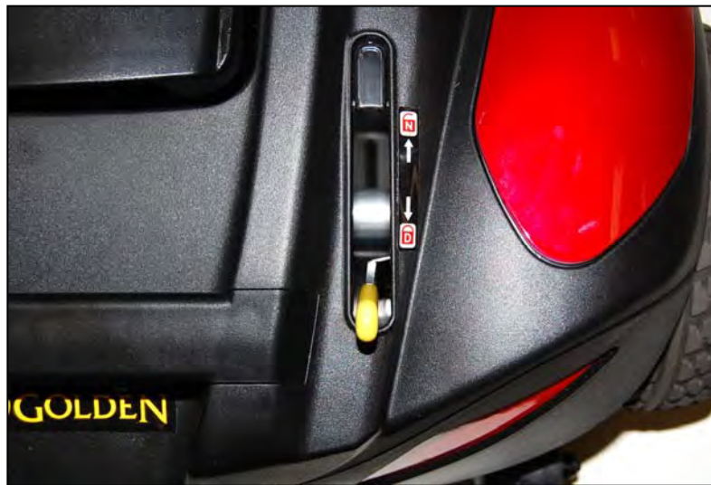
Imagen 11: Palanca rueda libre (En Drive)
