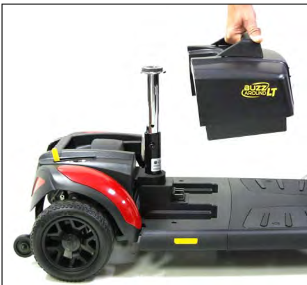
Imagen 21. Instalación de la batería
