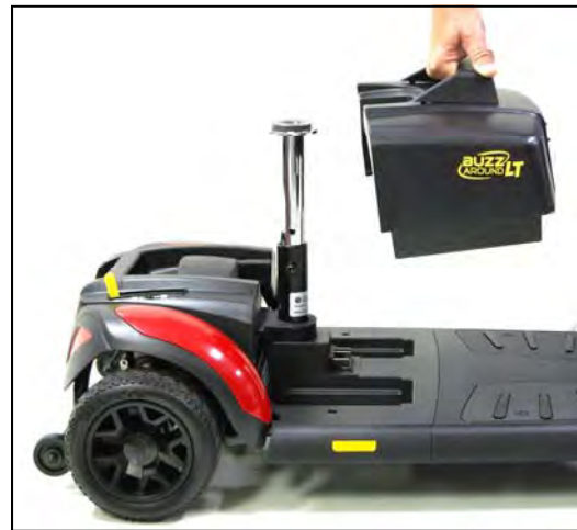
Imagen 15. Removiendo la batería
